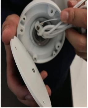
B. Konnektör kameraya bağlanır
