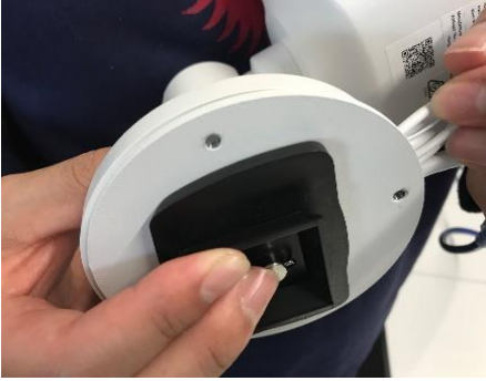
B. Konnektör kameraya bağlanır
